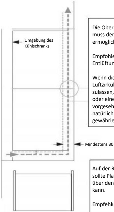
Draufsicht auf den Hinterlüftungsspalt
