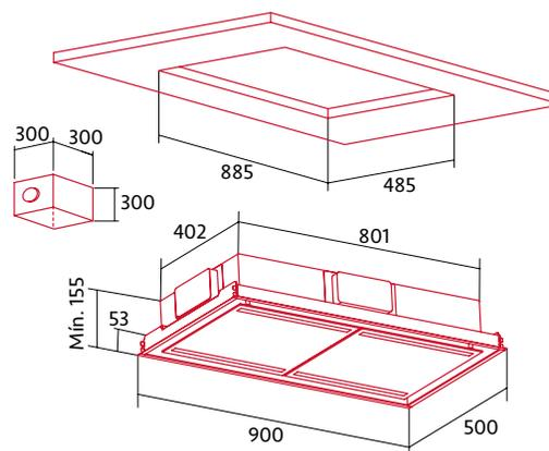
Instalación del motor independiente de la campana a una distancia de hasta 5 m (con cable suministrado) o 10 m (con accesorio)
